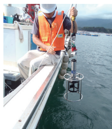
図1：船上から海中に水温塩分計を降ろしている様子
