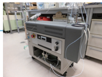
廃液を処理する超臨界水酸化小型装置
