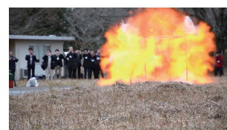
図2 柿岡教育研究施設での水素／空気ガス爆発デモ実験の様子
